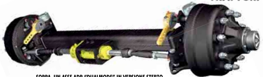
SOPRA, UN ASSE ADR "DUALMODE" IN VERSIONE STERZO COMANDATO. SOTTO, LO STESSO ASSE IN ALLESTIMENTO AUTOSTERZANTE. DA TALI SISTEMI NASCONO GLI ASSI AUTOSTERZANTI ASSISTITI, SOLUZIONI OTTIMALI PER EQUIPAGGIARE I FUTURI RIMORCHI DI ELEVATE PORTATE E VELOCITÀ
